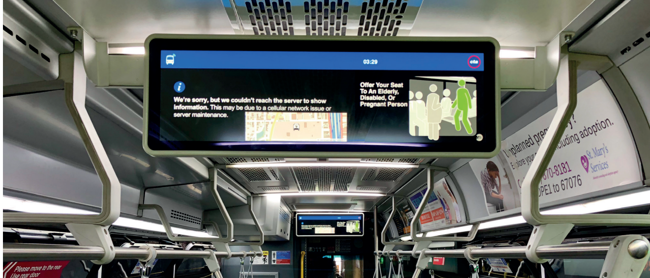
In Chicago wird DFI und Infotainment mit 2 Stretch Displays pro Bus gelöst (Werkbild: VIANOVA).
