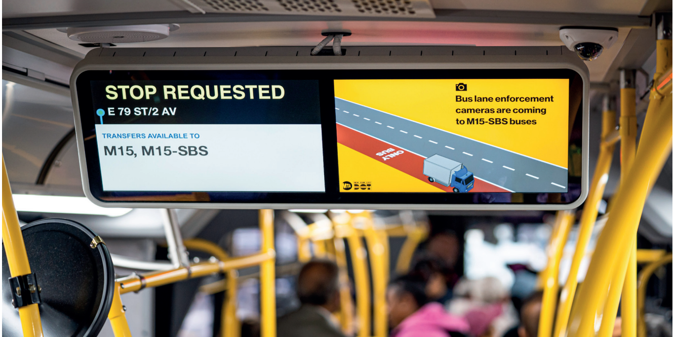
Die Busse in New York sind mit 2 oder 3 TWIN Displays von VIANOVA ausgestattet (Werkbild: VIANOVA).
